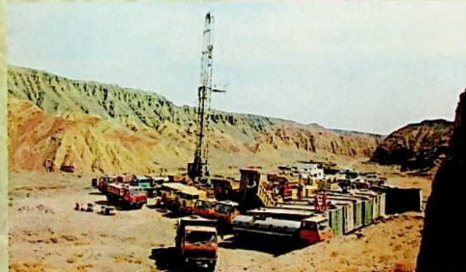
تۇرپان - قۇمۇل نېفىتلىكى قېدىرىپ تەكشۈرۈش - ئېچىشقا قۇماندانلىق قىلىش شىتابى قۇدۇق ئاستى تېخنىكا مەشغۇلات شىركىتى خالقارلىق ئىلغار سۈپىتىگە يەتكەن نېفىت گاز قۇدۇقى مەشغۇلات كەسپى شىركىتى . سۈرەتتە ، بېسىم بىلەن قىلام يېرىش مەشغۇلاتى ئېلىپ بېرىلماقتا .
