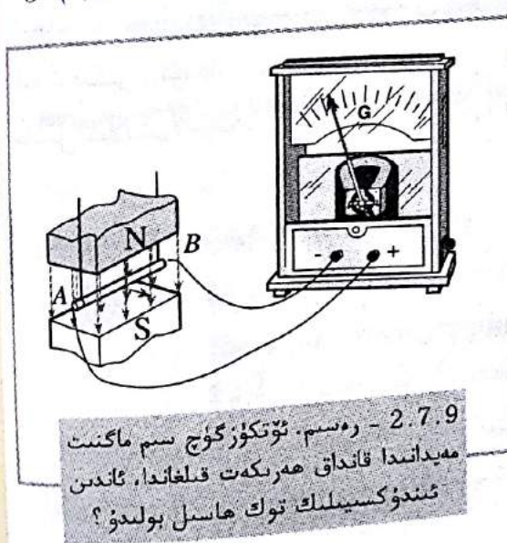
1.7.9 - رەسىم. قانداق ئەھۋالدا ئۆتكۈزگۈچ ماگىنت مەيدانىدا توكنى ھاسىل قىلالايدۇ؟
