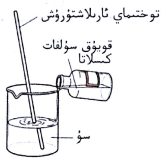
5.10 - رەسىم. قويۇق سۇلفات كىسلاتانى سۇيۇق سۇغا قۇيۇشنىڭ توغرا مەشغۇلاتى
