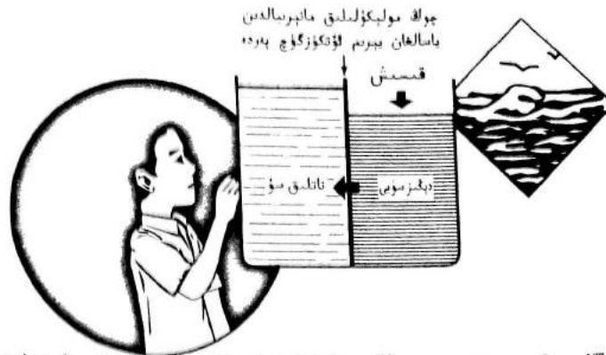
۷۸ . 9 - رەسىم . چوڭ مولېكۇلىلىق ئايرىغۇچ پەردە ئارقىلىق دېڭىز سۈيىنى تاتلىق سۇغا ئايلاندۇرۇش
