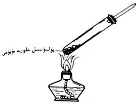
22 - رەسىم . پولىۋىنىل خلورىدنىڭ ئىسسىقلىق تەسىرىدە پارچىلىنىشى
