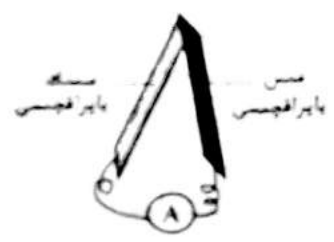
10 - رەسىم - سىزگۈر گالۋانىومېتىر ئارقىلىق سىنك ياپراقچىسى بىلەن مىس ياپراقچىسى ئارىسىدا توك ئۆتكۈزۈش ئۈنۈمىگە ئىگىلىكىنى تەكشۈرۈش
