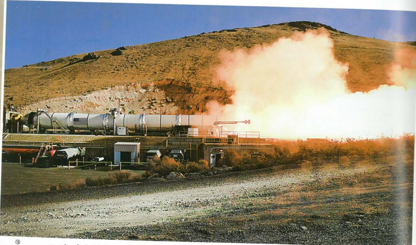
⑤ بۇ ئامېرىكا تەتقىق قىلىپ ياساۋاتقان «DM-2» ناملىق موتور، ئۇ ھازىر ئىتتىرىش كۈچى ئەڭ كۈچلۈك قاتتىق يېقىلغۇلۇق راکېتا موتورى ھېسابلىنىدۇ
