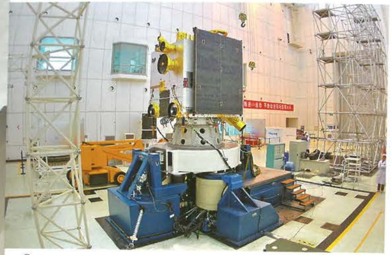
«ئاي پەرىسى - 1» ناملىق ئاي شارىنى تەكشۈرۈش سۈنئىي ھەمراھى تەۋرىتىش سىنىقى قىلىنماقتا
