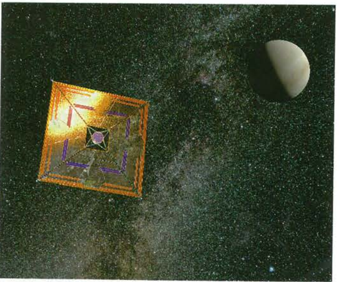
«ئىكاروس» ناملىق تەجرىبە قۇياش يەلكىنىنىڭ بىر تەرىپىدە دىئاگونال ئۇزۇنلۇقى 20 مېتىرلىق چاسا يەلكەن بار، ئۇ پولىئىمىدىن ياسالغان، قېلىنلىقى ئاران 0.0075 مىللىمېتىر كېلىدۇ
