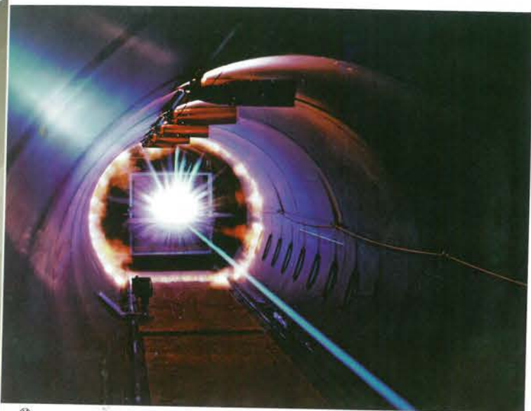
ئالەم ئۇچقۇسى ئالەم بوشلۇقى ئەخلەتنىڭ زەربىسىگە ئۇچراش ئەھۋالى ھەققىدە يەردە ئۆتكۈزۈلگەن تەقلىدى تەجرىبە
