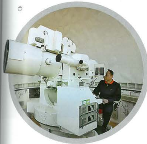
ئوپتىكىلىق رادار ئارقىلىق ئۆلچەش پوندىكتىن ئىختىيارلىق راکېتانىڭ ئۇچۇش ئەھۋالىنى ئىز قوغلاپ ئۆلچەمەكتە
