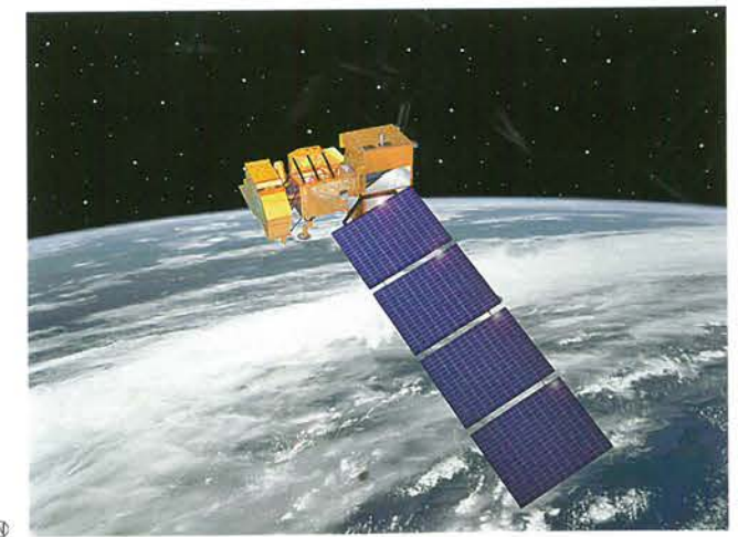
ئامېرىكىنىڭ «قۇرۇقلۇق - 7» ناملىق بايلىق سۈنئىي ھەمراھىدا ئۈچ ئوقلۇق مۇقىملىقىنى ساقلاش ئۈسۈلى قوللىنىلغان
