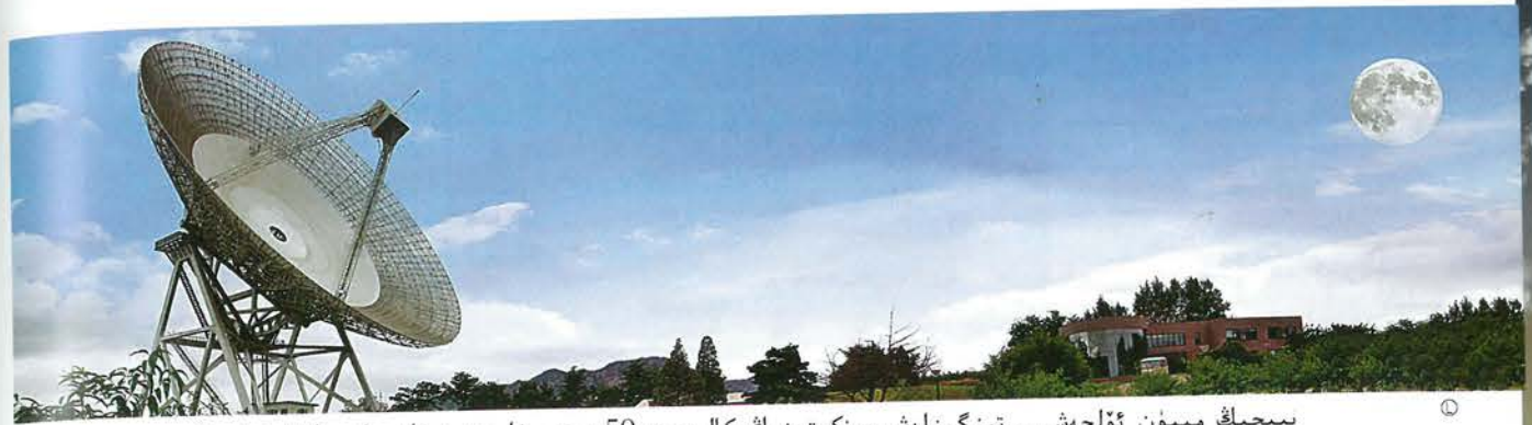
بېيجىڭ مىيون ئۆلچەش - تىزگىنلەش پونكىتىنىڭ كالىبرى 50 مېتىرغا يېتىدىغان رادىيولۇق تېلېسكوپى
