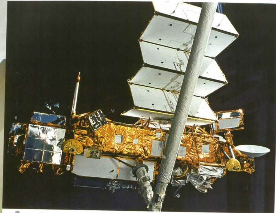
ئامېرىكىنىڭ يۇقىرى ئاتموسفېرا قەۋىتى تەتقىقاتىغا ئىشلىتىلىدىغان سۈنئىي ھەمراھى قۇياش ئېنېرگىيەلىك باتارىيە تاختىسى قانئىتىنى يايماقتا
