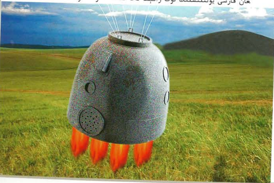
«خاسىيەتلىك كېمە - 8» ناملىق ئالەم كېمىسىنىڭ قايتۇرۇپ كېلى- نىدىغان بۆلۈمى يەرگە قونۇشقا ئاز قالغاندا، ئۇنىڭ تېگىگە ئورنىتىل- غان قارشى يۆنىلىشلىك تۆت راکېتا تەڭ ئىشقا كىرىشىدۇ
