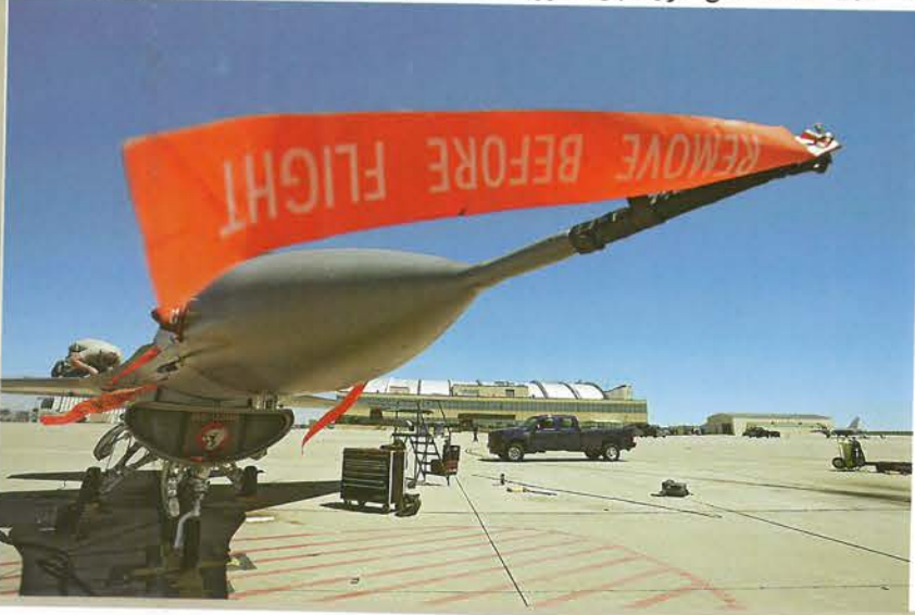
«F-16» ناملىق كۈرەشچى ئايروپىلاننىڭ ھاۋادىكى تېزلىكىنى ئۆلچەش زوندى
