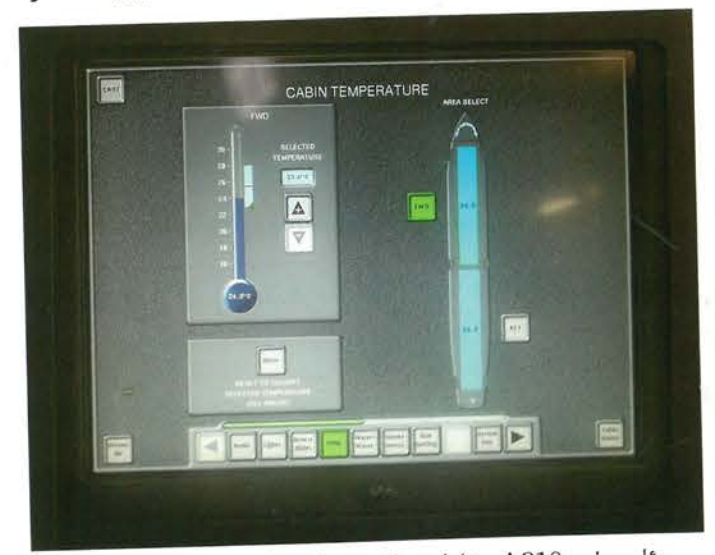
© «ئايرىپىلان A319» ناملىق ئايرىپىلاننىڭ يولۇچىلار بۆلۈمىنى تىزگىنلەش سىستېمىسى
