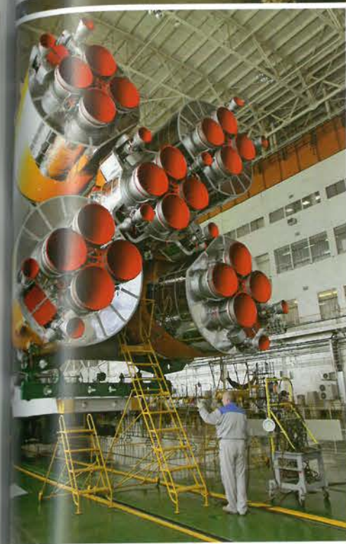
④ رۇسىيە «ئىتتىپاق» ناملىق توشۇغۇچى راکېتاسىنىڭ موتور پۈرۈش ئېغىزى
