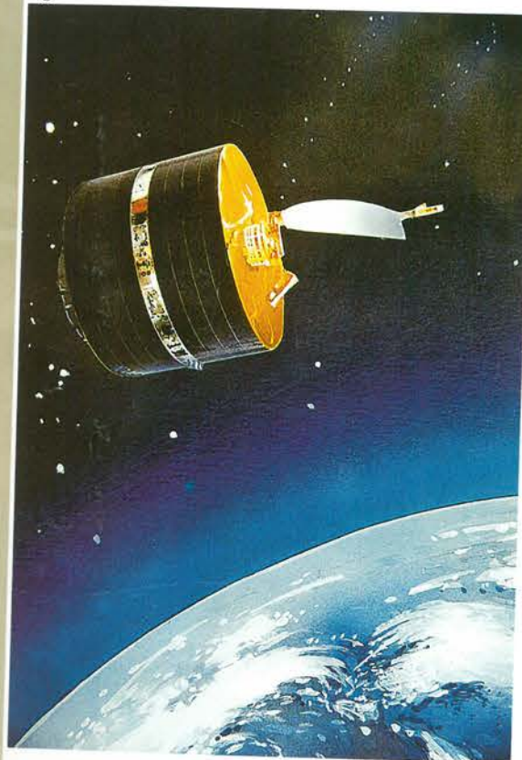
«شەرق قىزاردى - 2A» ناملىق ئالاقە سۈنئىي ھەمراھىدا ئۆز ئوقىدا ئايلىنىپ مۇقىملىقىنى ساقلاش ئۇسۇلى قوللىنىلغان
