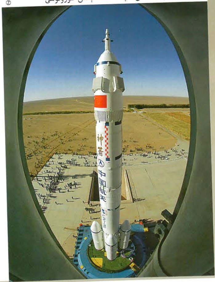
«ئۇزۇن سەپەر - 2FT1» ناملىق راکېتانىڭ ھاۋا ئېقىمىنى تەڭشەش قاپقىمىنىڭ ئېنىق كۆرۈنۈشى
