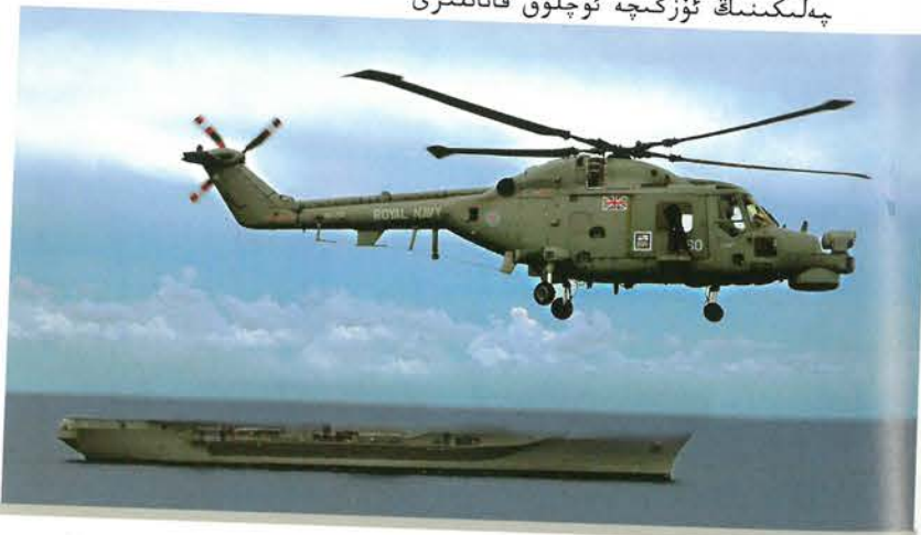
«تاغ مۈشۈكى» ناملىق تىك ئۇچار ئايروپىلان چاق- پەلەكنىڭ ئۆزگىچە ئۇچلۇق قاناتلىرى
