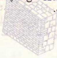
بۆلۈڭنى قوپۇرغاندا بوي ياكى توغرا تامدىن ھەر 4-6 قۇر خىش ئېگىزلىكىدە 120mm دىن كىچىك بولمىغان قۇلاق بىلەن توغرا ياكى بوي تامغا چىشلەشتۈرۈش كېرەك.
