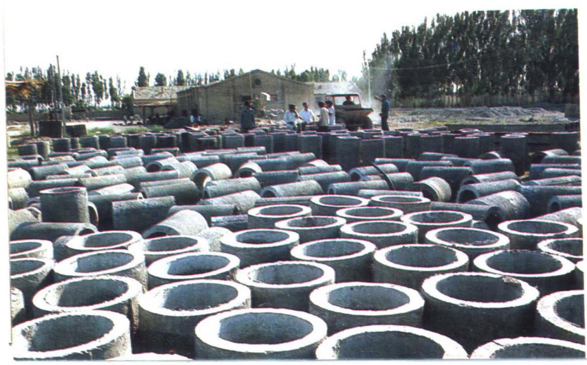
ناھىيىلىك سۇ قۇرۇلۇش بويۇملىرىنى ئالدىن تەييارلاش زاۋۇتى ئىشلەپچىقارغان سۈزگۈچ تۇرۇبا
